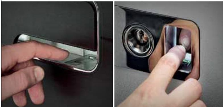
Fingerscan Arte unauffällig und fast unsichtbar im Türflügel, in Aussenstosgriffen oder im Kratzschutz verbaut
